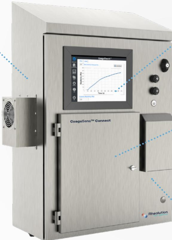
Interagissez avec le CoaguSens<sup>MC</sup> Connect à partir de l'écran tactile de l'instrument.
